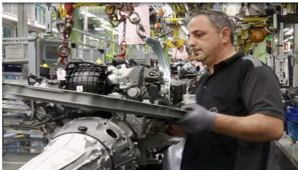
Mercedes-Benz Werkteil Hulb: In der Motorenendmontage werden vorgefertigte Motoren aus Werken wie Untertürkheim oder Bad Cannstatt angeliefert. Hier werden sie entsprechend der Kundenbestellung fertiggestellt. Hier können Sie hinter die Kulissen blicken.
